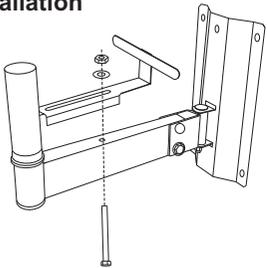
Fissare la guida per blocco diffusore utilizzando la viteria fornita (se necessario).
